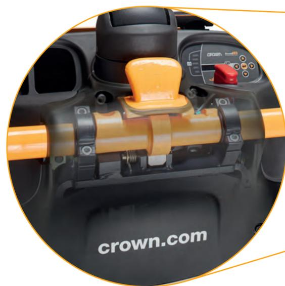
**As proteções laterais reforçadas possuem tubos de aço de parede resistente de 50 mm de diâmetro e um sistema de montagem robusto com braçadeira C.**
