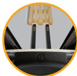
A visibilidade através do mastro é de classe superior devido à construção da viga em I aninhada e um carro porta-garfos que minimiza obstruções.
