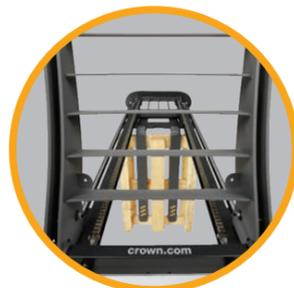
Uma proteção superior de alta visibilidade oferece aos operadores uma visão melhor para posicionar garfo e cargas em alturas elevadas.
