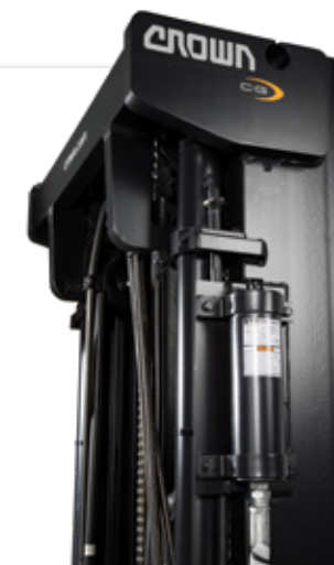
Acumulador hidráulico opcional Amortece os movimentos do carro porta-garfos ao conduzir em superfícies irregulares
