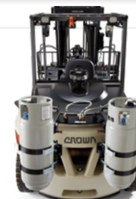
Suportes de tanque LP com dupla articulação para fora e para baixo Para maior conveniência, faça o upgrade para os suportes de tanque com dupla articulação para fora e para baixo para facilitar ainda mais os reabastecimentos.
