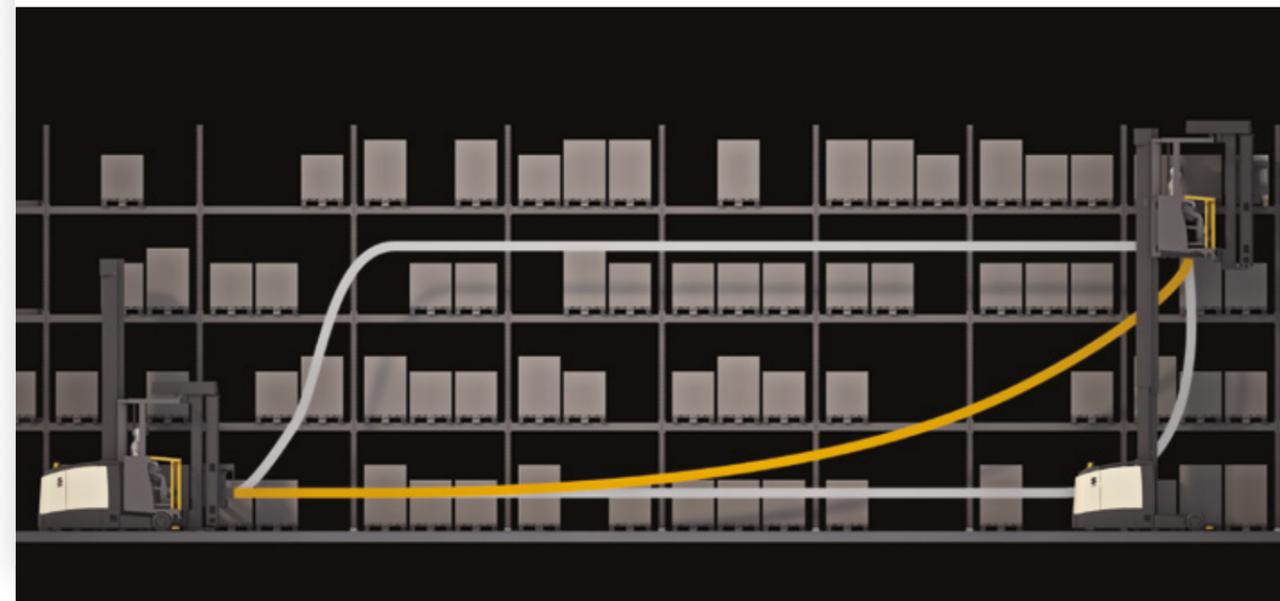
**O Auto Fence (Limite Automático)** desacelera ou interrompe o deslocamento e limita a altura de elevação no corredor muito estreito com base na localização da empilhadeira.
