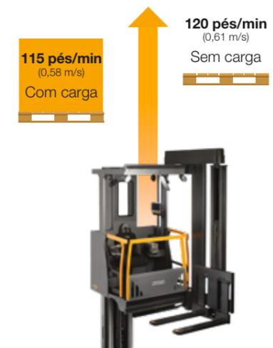
Além de ser líder do setor em termos de velocidade de deslocamento/elevação e desempenho das baterias, a Crown oferece o que há de mais recente em termos de tecnologia de assistência ao operador, com o Auto Positioning System (Sistema de posicionamento automático) e o controle de tração antiderrapante OnTrac, para aprimorar ainda mais o desempenho da sua operação.
