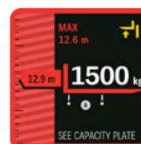
**Vermelho** — a carga excede a capacidade ou está acima do limite de altura de elevação.
