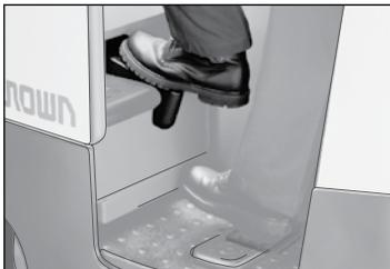
Pise el pedal del freno central del pedestal con el pie izquierdo. Esta acción permite que el sistema electrónico del montacargas compruebe si el pedal del freno funciona antes de conducirlo.
