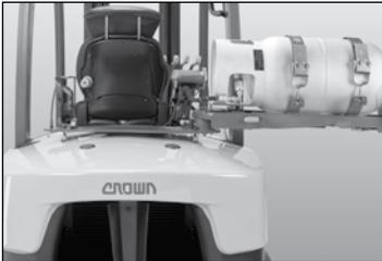
**Precaución:** No use el montacargas con el tanque en la posición inferior.
