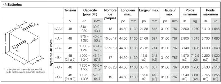
Emplacement/longueur du connecteur (J): A/15 po (A/381 mm). Connecteurs standard: « AA », « A », « B », « C » 48 V = SB350 bleu; « B », « C » 48 (24 x 2) V = SB350 rouge.
