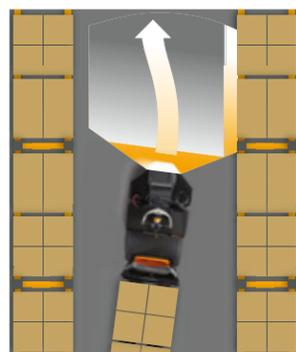
La technologie de **correction automatique de la direction** détecte la proximité du chariot par rapport à des objets comme les rayonnages, et ajuste automatiquement sa trajectoire de déplacement. Cela se traduit par une réduction des dommages et des interruptions au cours de la prélèvement.
