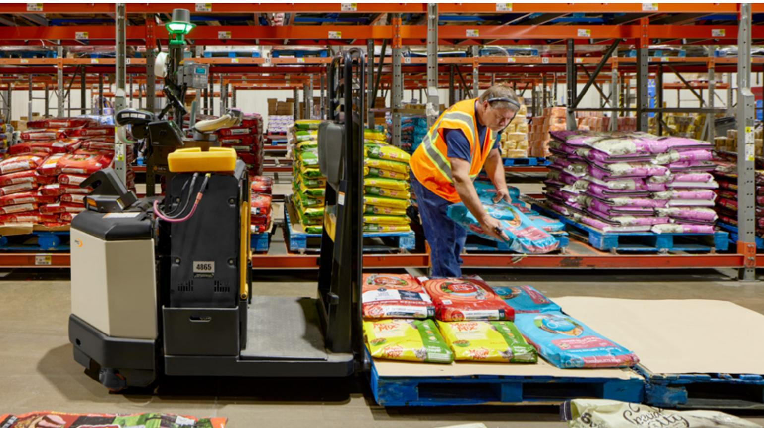
Au-delà des gains de productivité, placer le cariste au point idéal de prélèvement (derrière le chariot) augmente la sécurité. De plus, les fonctions de correction automatique de la direction et de détection d'obstacles permettent de réduire les dommages associés à la navigation fréquente du chariot.
