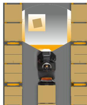
Les lasers intégrés de **détection des obstacles** détectent les obstacles sur la trajectoire du chariot et appliquent automatiquement les freins en cas de besoin. Cela se traduit par une réduction des dommages aux produits comme aux rayonnages.
